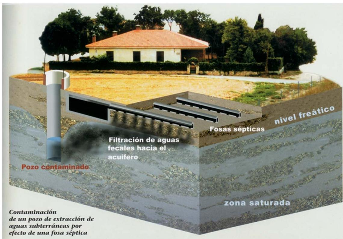
*Ilustración 16: Contaminación del agua en un pozo por efecto de una fosa séptica.*
