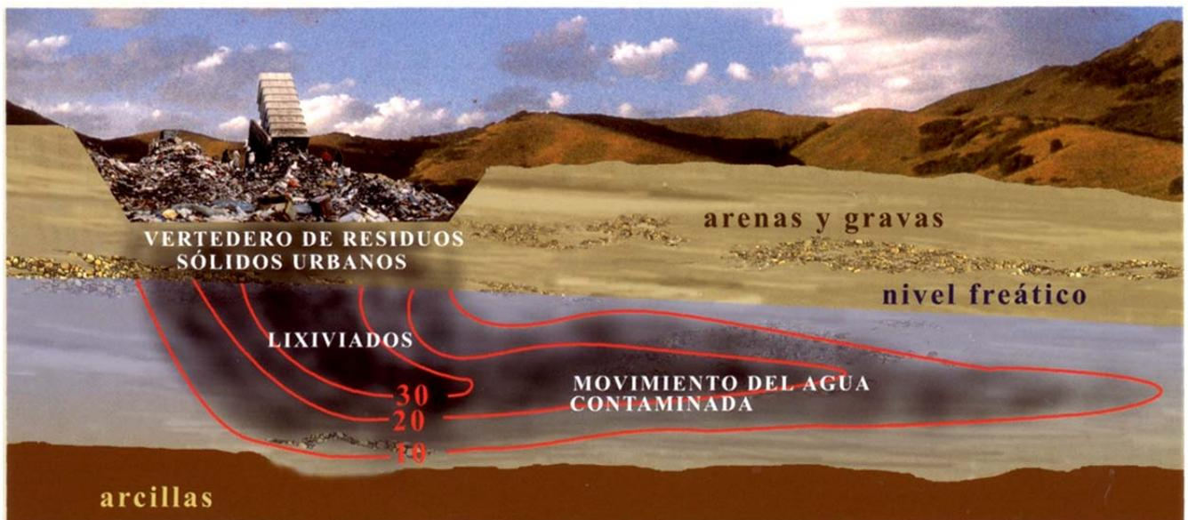
Ilustración 17: Contaminación del agua subterránea por lixiviados de un vertedero de residuos urbanos.
