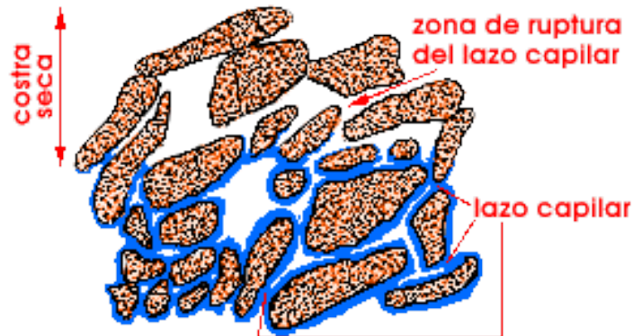
Figura 17: Concepto de la formación de la costra seca en los suelos.
