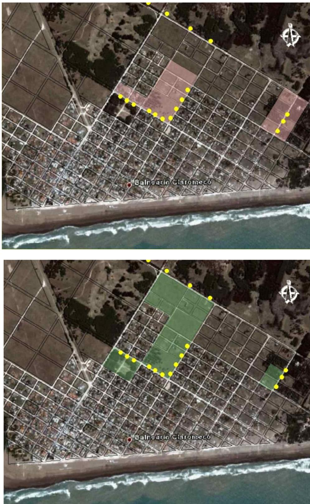
Figura 3. Zona de Reserva Hidrológica definida por el SPAR (superior) y Zona de Reserva Acuífera impuesta por el Municipio (inferior). Los puntos color amarillo son los pozos de explotación.
