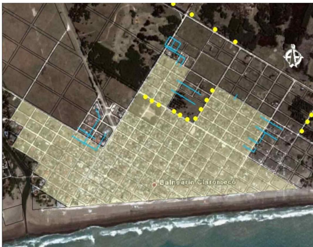
Figura 2. Zona servida con agua potable, en azul la extensión de la red de abastecimiento y pozos de explotación (amarillo).
