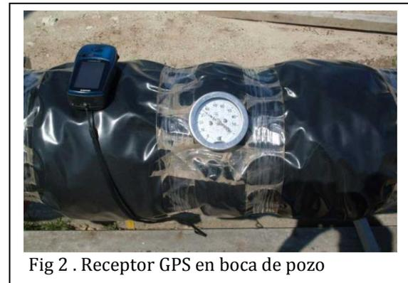
Fig 2 . Receptor GPS en boca de pozo
