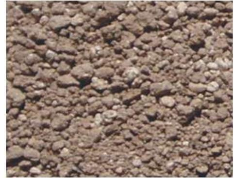
Figura 29. Fotografía del cutting de los sedimentos cuspidales de un sondeo correspondientes al Pampeano y Pospampeano
