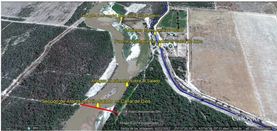
En rojo, sección de aforos sobre el Río Salado. En azul, Canal de Dios Ubicación: 25°37'40.05\"/>
