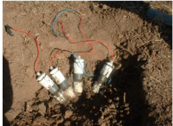
*Medición del campo eléctrico. Electrodos.*
