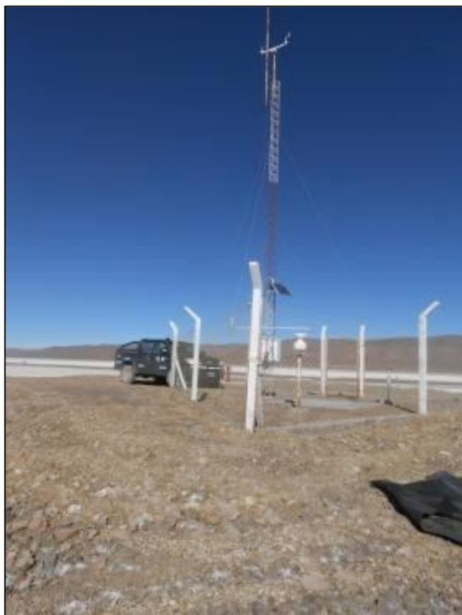
**Foto 1. Estación meteorológica Vaisala.**
