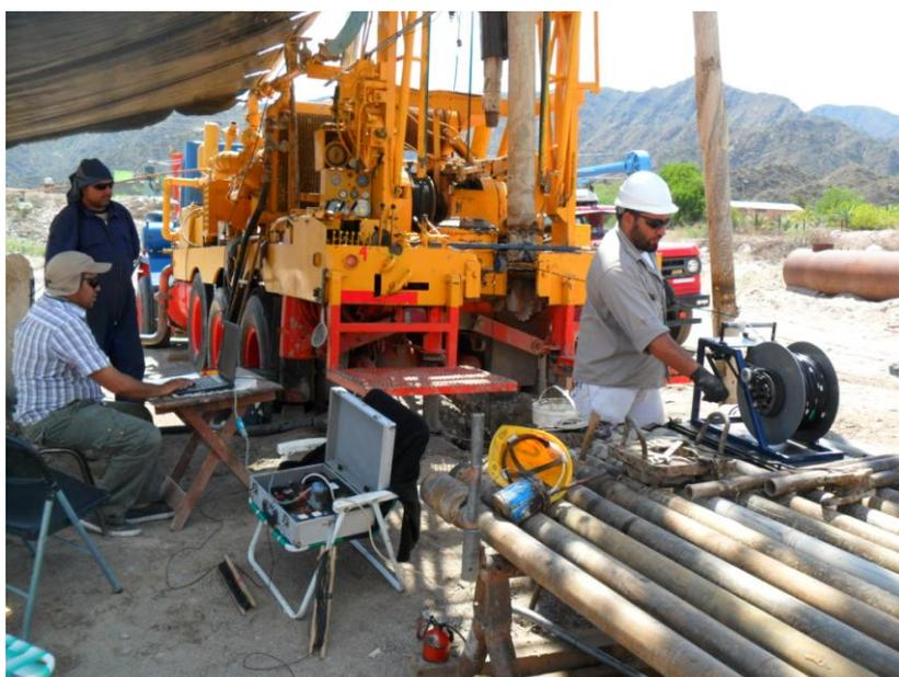
Foto 2: Realización del perfilaje eléctrico computarizado.
