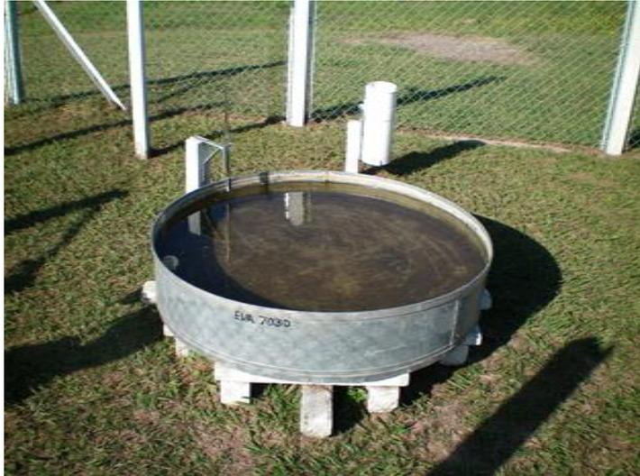
Foto 2: Tanque de evaporación en Estación Meteorológica Río San Francisco (provincia de Jujuy).
