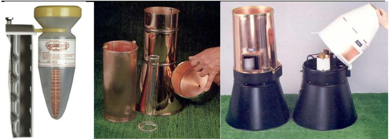
Foto 1: A la izquierda, pluviómetro ordinario. Al medio pluviómetro totalizador. A la derecha pluviógrafo.
