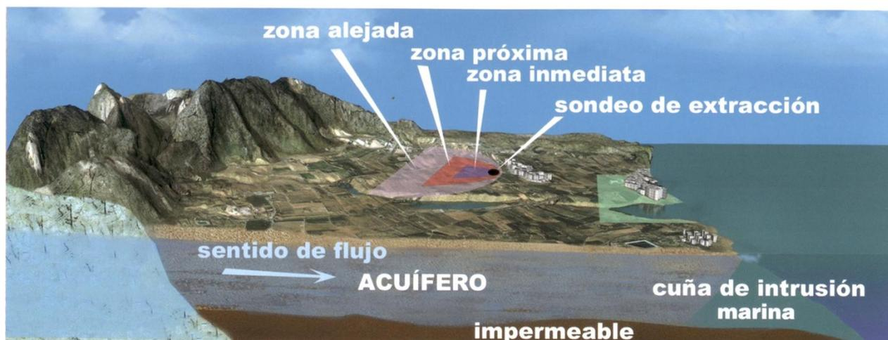
Ilustración 29: Concepto y esquema de perímetros de protección.
