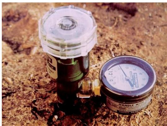
Foto 3: Tensiómetro para medir cambios de humedad en el suelo.
