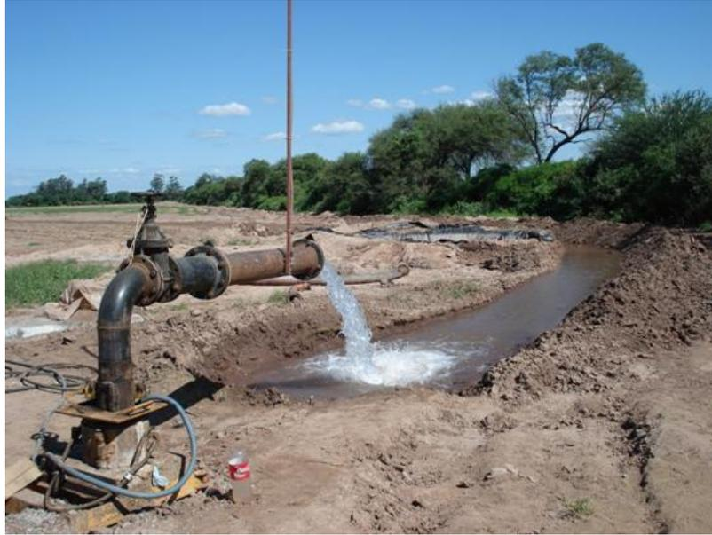
*Foto 49: Medición de caudal mediante el sistema Pitot o placa orificio en un pozo en la localidad de Yuchán (Provincia de Salta).*
