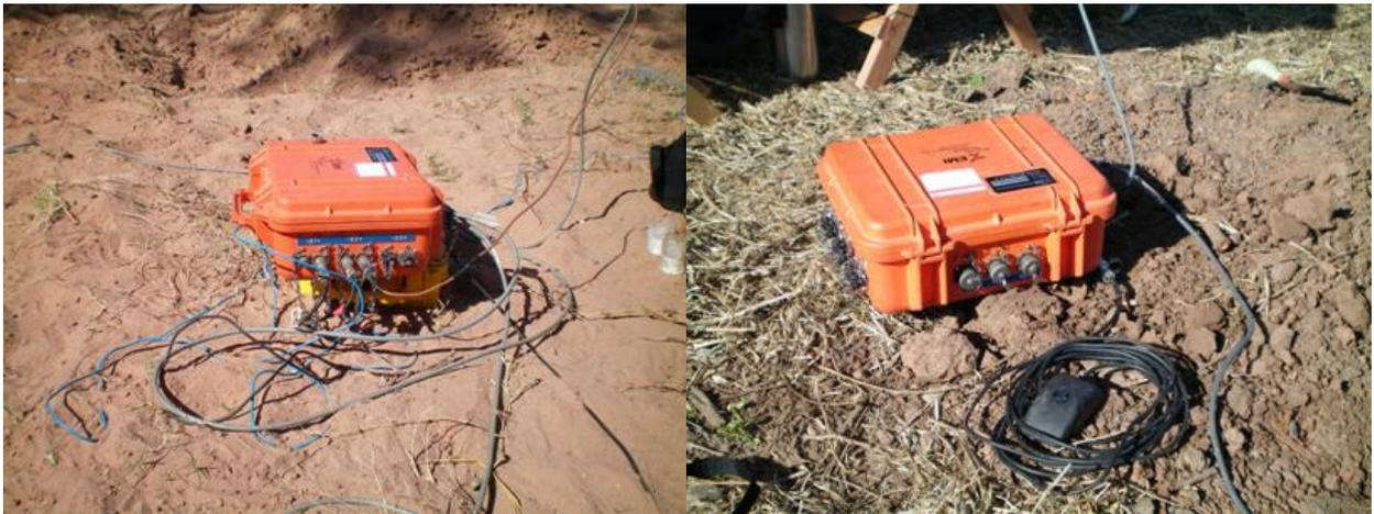
Foto 16: Equipo EMI. A la izquierda con conexiones a las barras magnéticas X, Y, Z y a los electrodos MN. A la derecha, conexión al sistema de GPS y PC. Gentileza del INGEIS.
