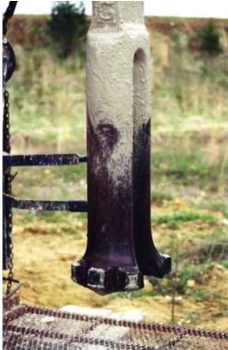
Foto 30. Trépano de un equipo de percusión.
