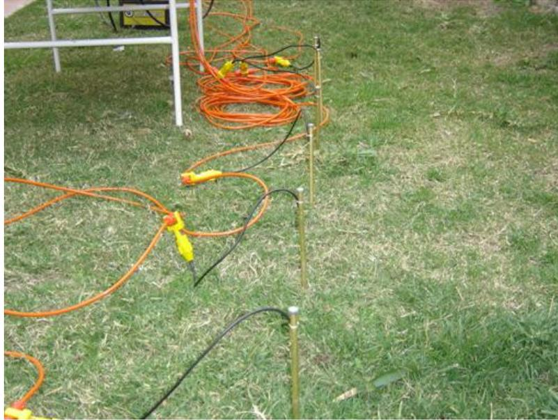
*Foto 15: Cables multielectrodos con nodos de contacto y electrodos.*
