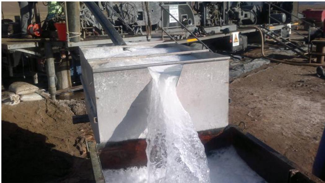
*Foto 52: Medición de caudal mediante sistema de vertedero en un pozo en el Salar de Cauchari (Provincia de Jujuy).*
