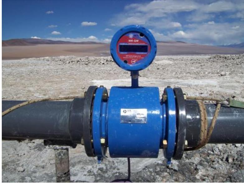
*Foto 51: Medición de caudal mediante sistema de caudalímetro digital totalizador en un pozo en el Salar de Río Grande (Provincia de Salta).*
