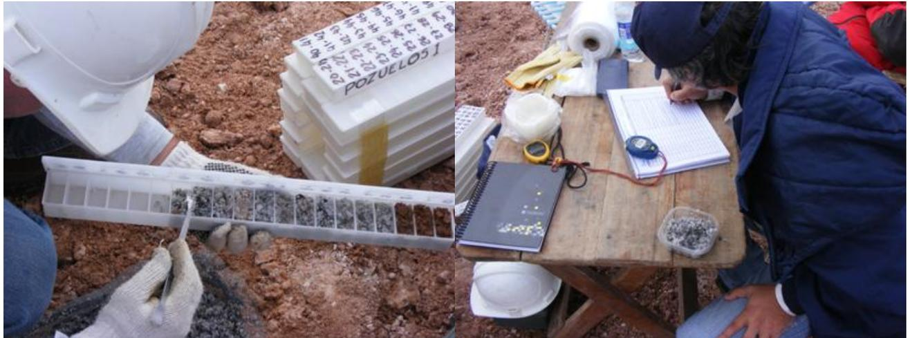
Foto 39. Muestreo y descripción de cutting proveniente de una perforación.
