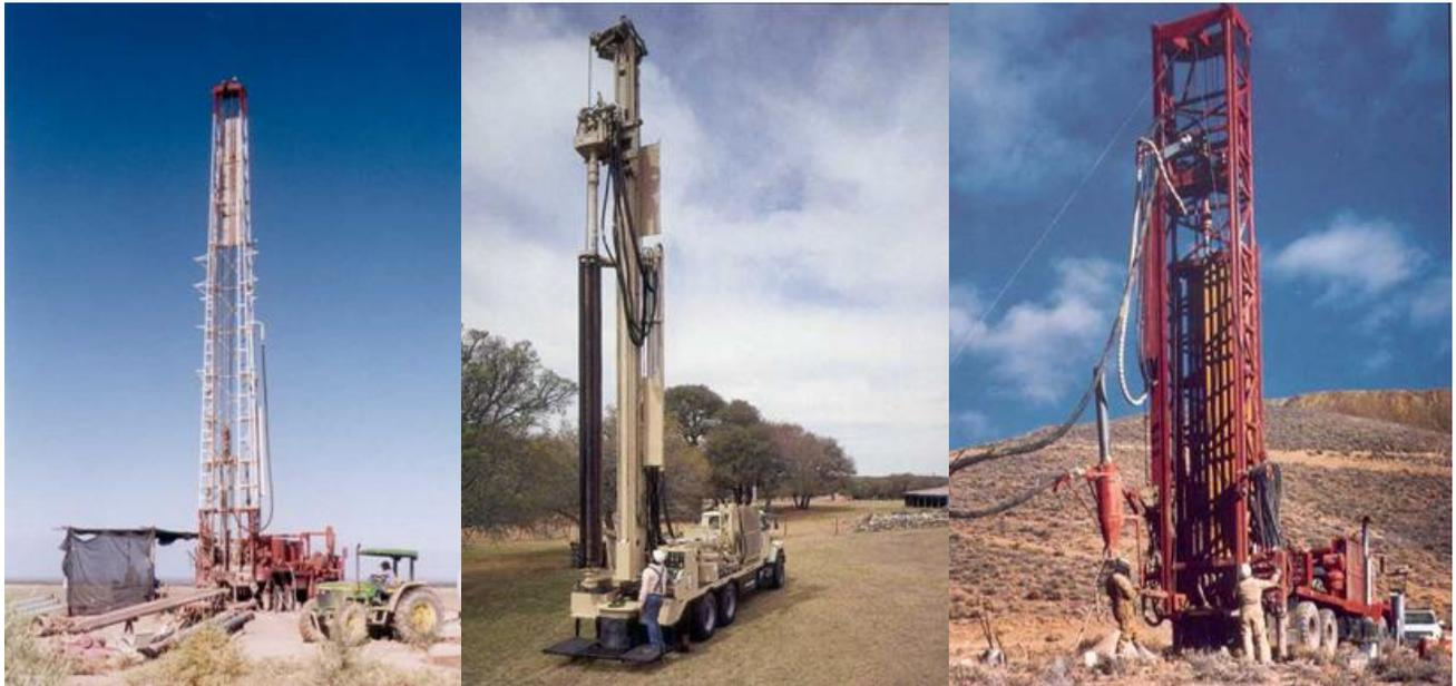
Foto 31: Equipos de perforación con sistema rotativo.
