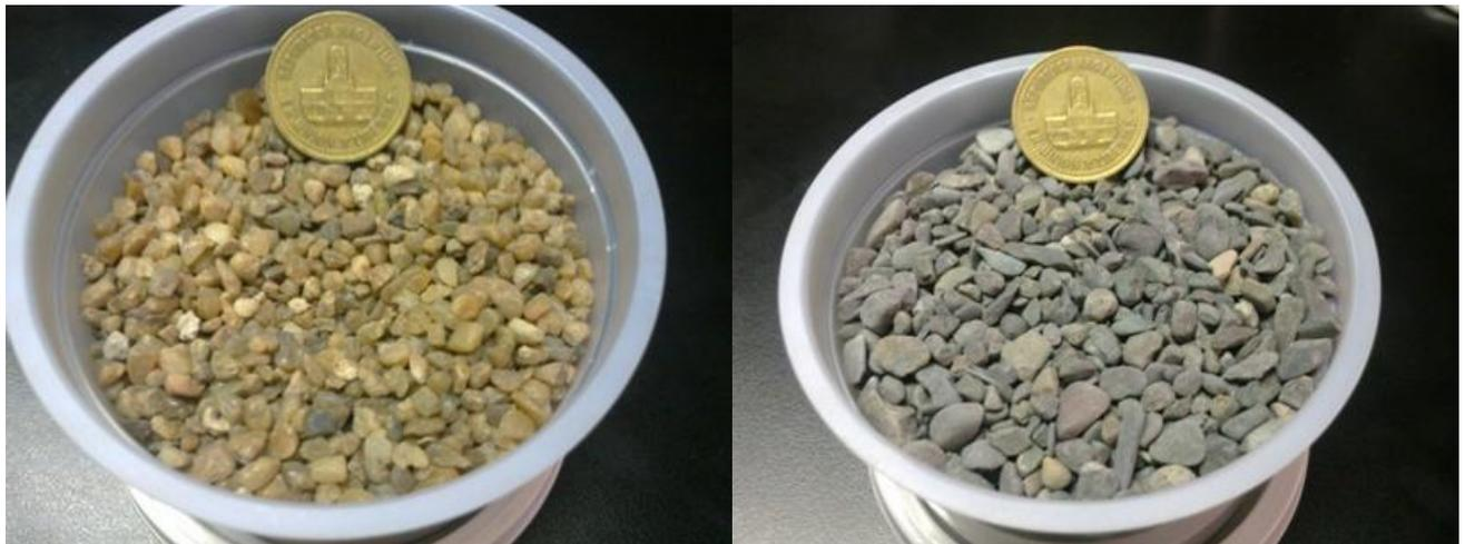
Foto 43: A la izquierda material prefiltrante constituido principalmente por cuarzo. A la derecha, material prefiltrante procedente de fragmentos líticos.
