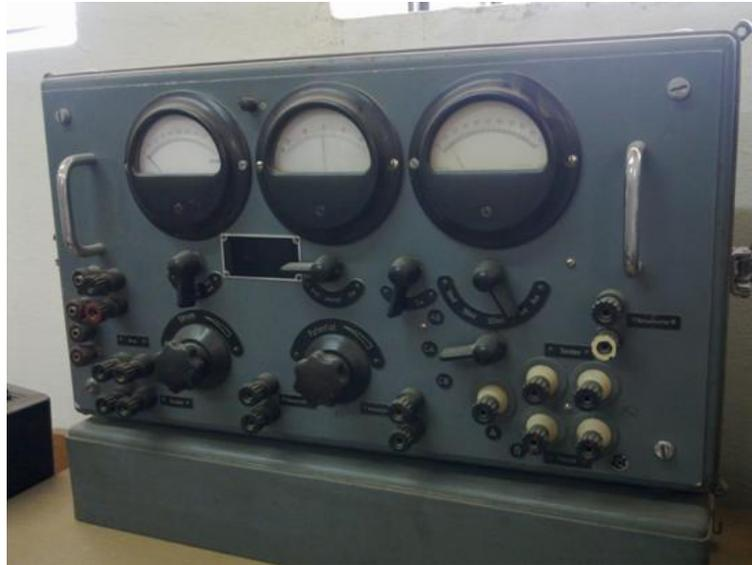
Foto 11: Equipo de prospección eléctrica en corriente continua (1970 – 1980).
