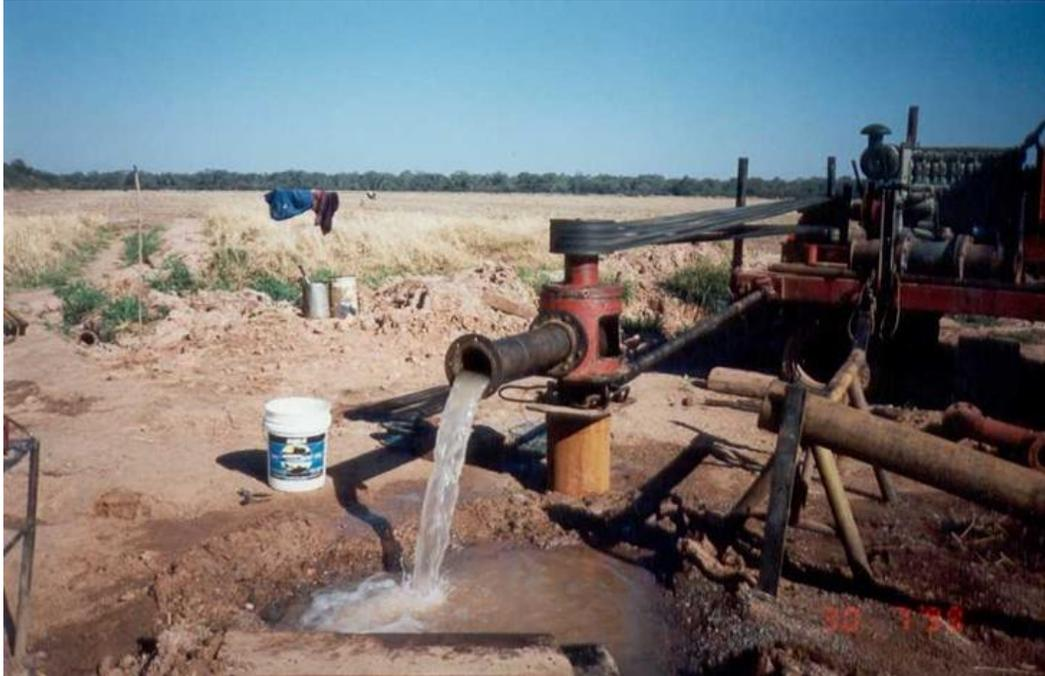
*Foto 48: Bomba de eje. Se observa cabezal sobre el pozo y correas de distribución accionada por motor cardánico (atrás).*
