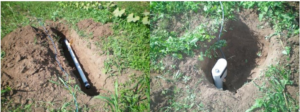
Foto 17: A la izquierda barra magnética X. A la derecha, barra magnética vertical (Z). En todos los casos las tres componentes del campo magnético se encuentran enterradas.
