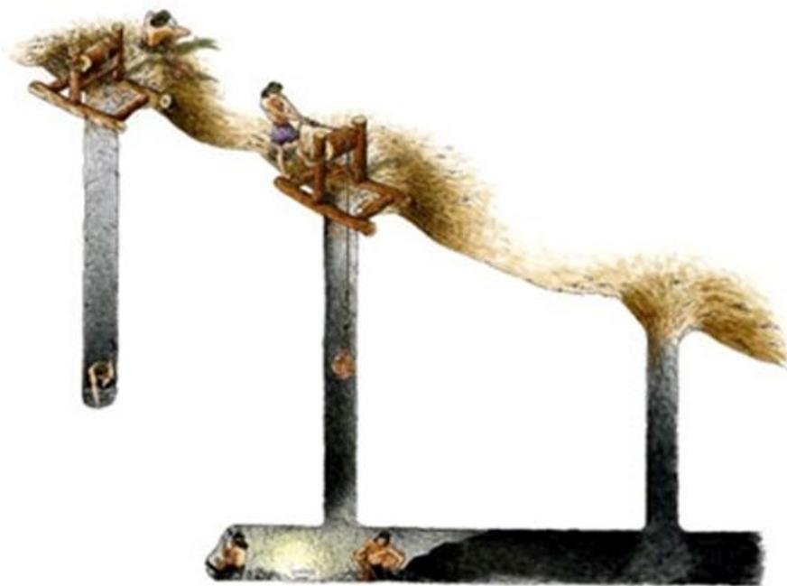
*Ilustración 39: Esquema de construcción de una galería.*
