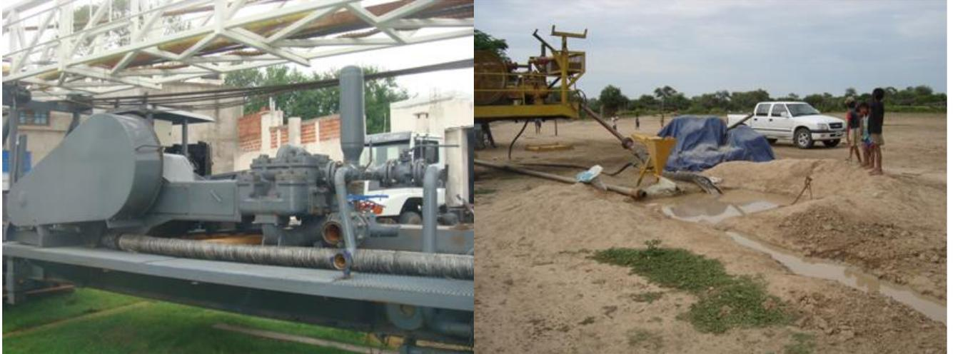
Foto 38: Bomba de lodo (izquierda) y piletas de inyección (derecha).
