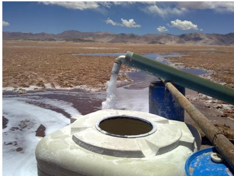
*Foto 50: Medición de caudal mediante sistema volumétrico en un pozo en el Salar del Hombre Muerto (Provincia de Catamarca).*
