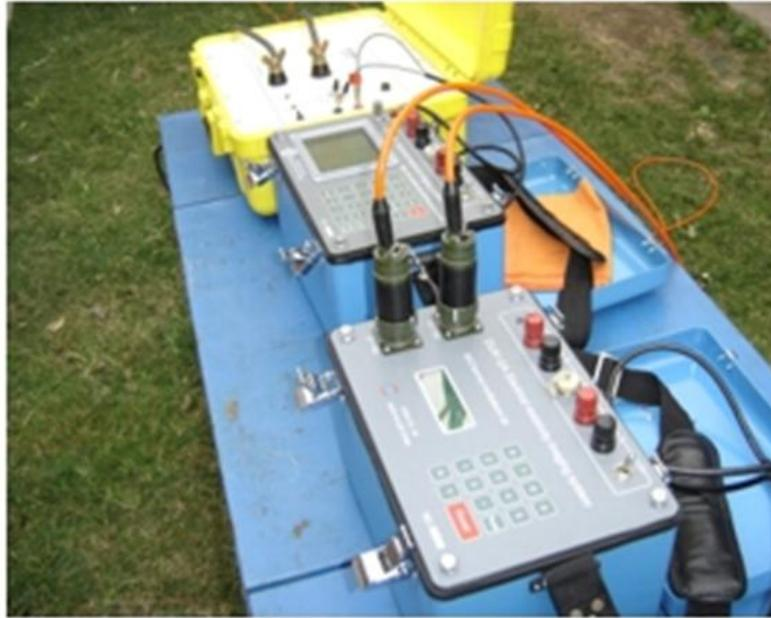
Foto 13: Equipo de prospección eléctrica en corriente continua (2010).
