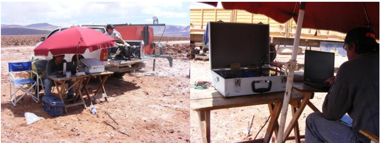
Foto 40. Equipo de perfilaje de pozos. Registro de SP, SPR, RNC, RNL y Gamma en el Salar de Pozuelos (Provincia de Salta).
