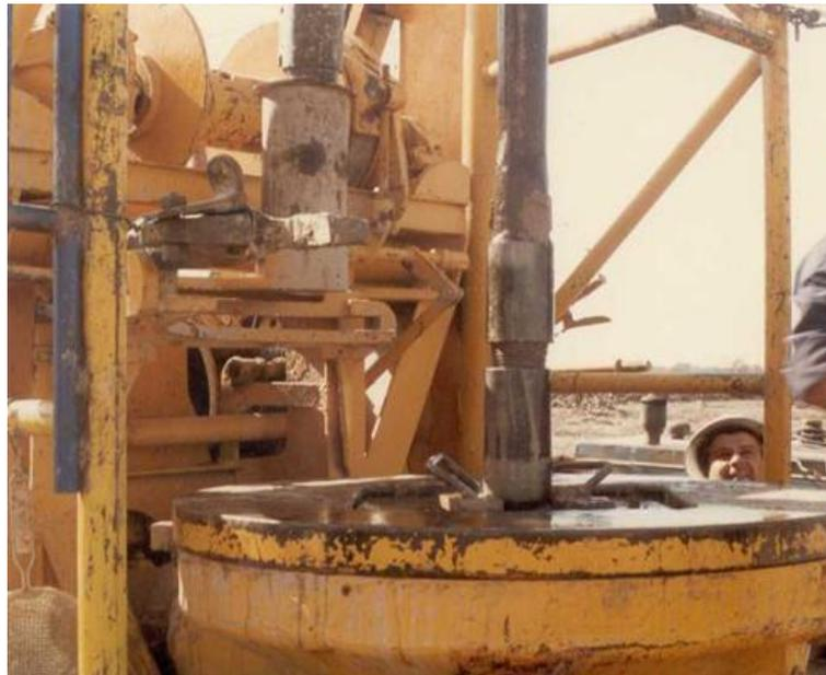
*Foto 34: Barras de sondeo. Se observa rosca macho y hembra, cónica.*
