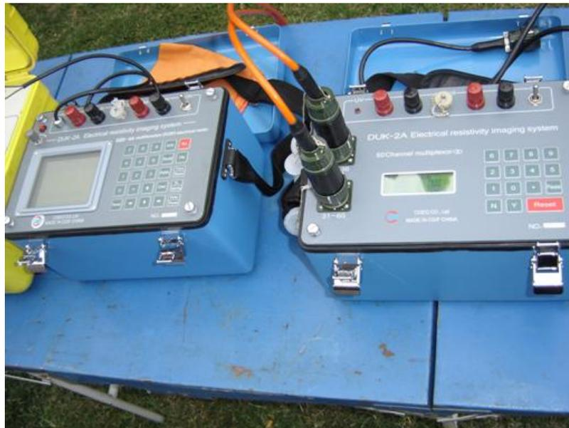
Foto 14: Equipo de registro de Tomografía Eléctrica.
