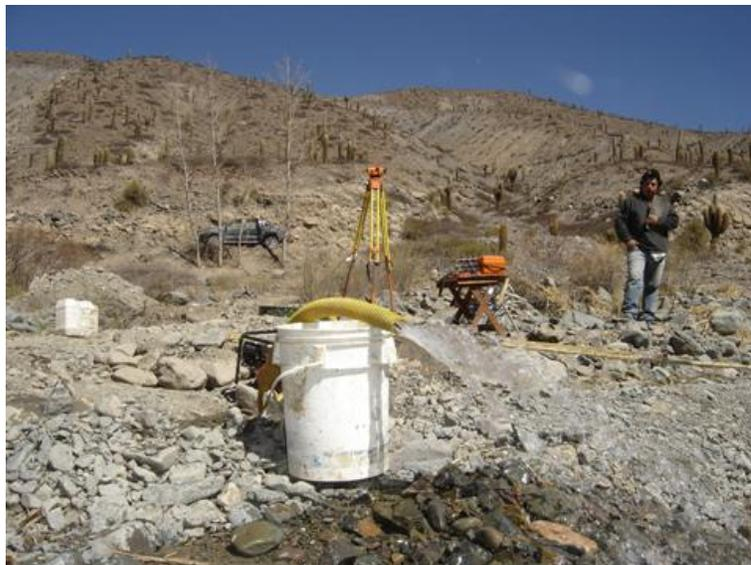
*Foto 20: Ensayo de bombeo en pozo excavado en la zona de futuro emplazamiento de dren (El Alfarcito, Salta).*
