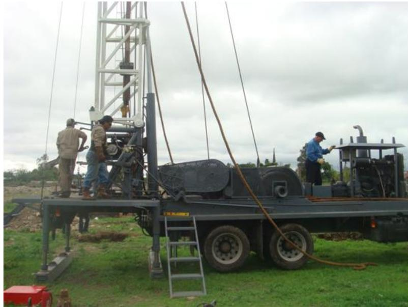
*Foto 35: En el mástil o torre, se observa suspendido el vástago y el cuadrante que se inserta en la mesa.*
