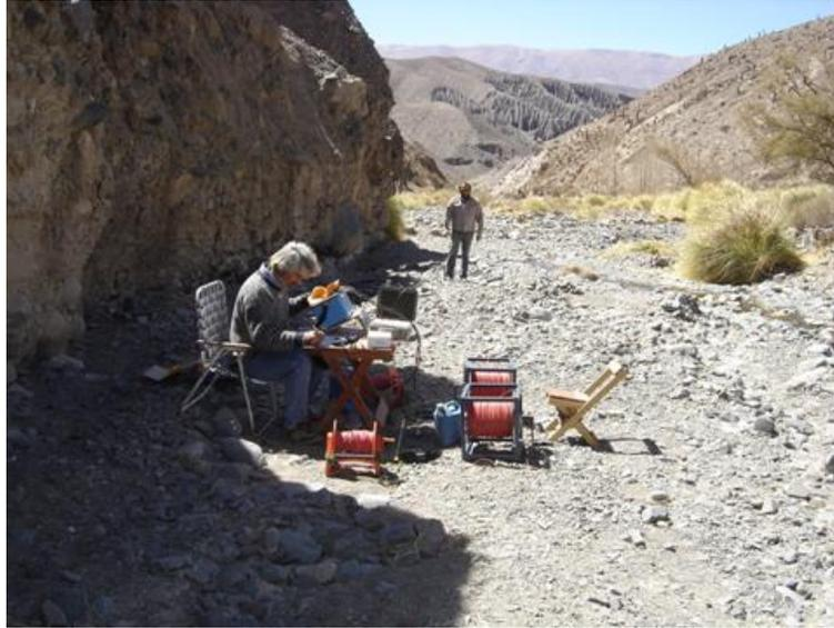
*Foto 19: Prospección geoelectrica en el valle del río Alfarcito (Quebrada del río Toro, Salta).*
