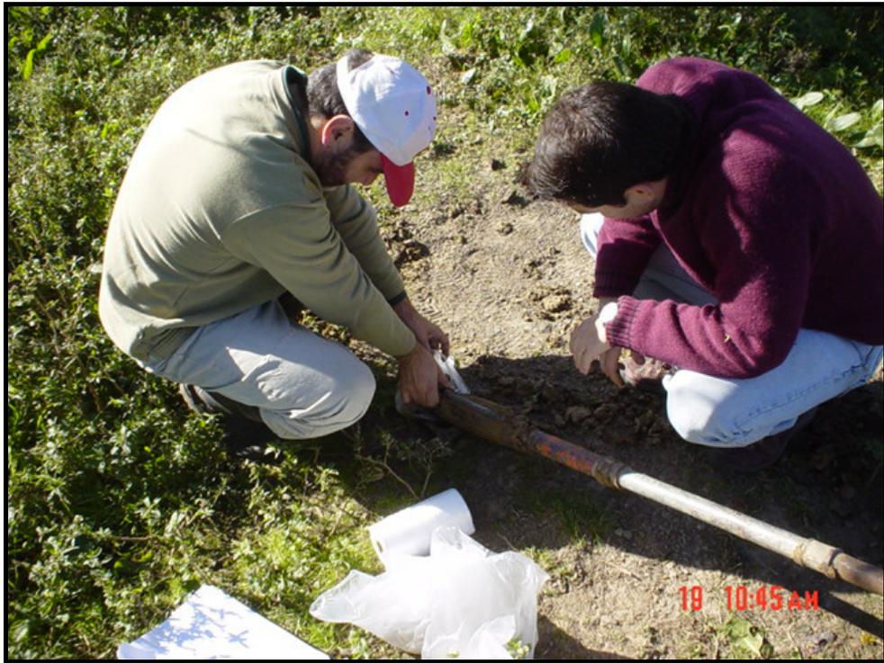
Foto 5: Extracción y análisis de la muestra barrenada .
