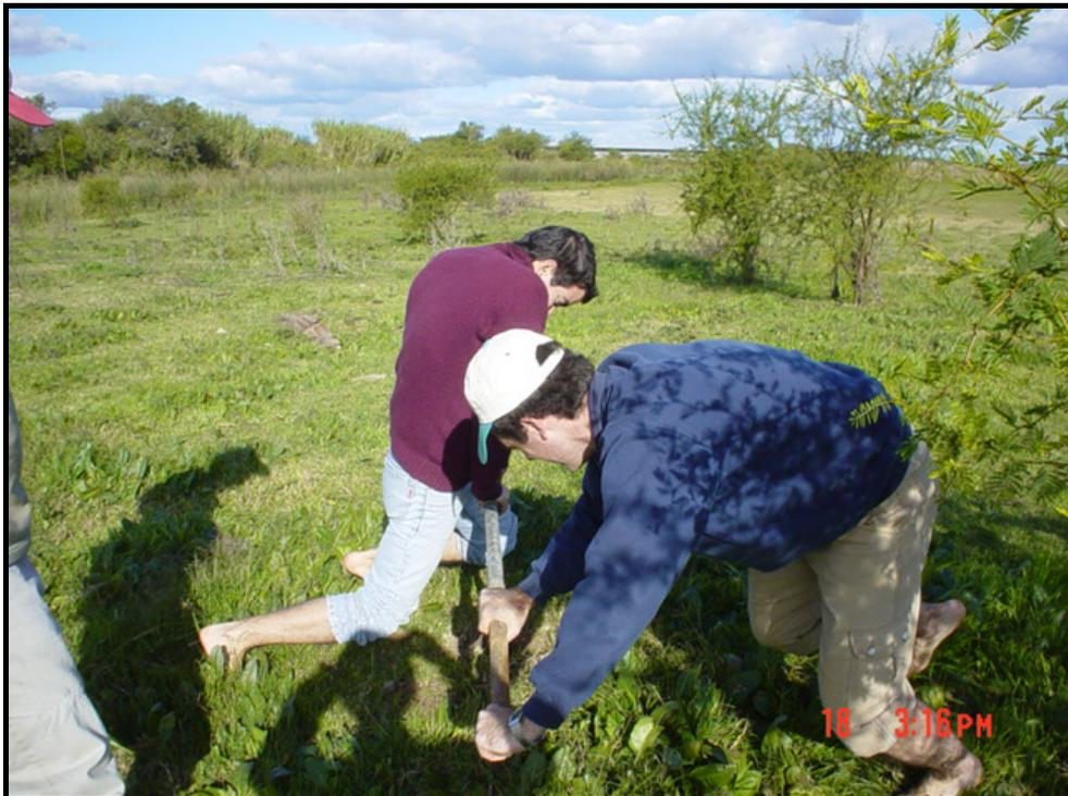
Foto 4: Toma de muestras sin disturbar con el uso del barreno.
