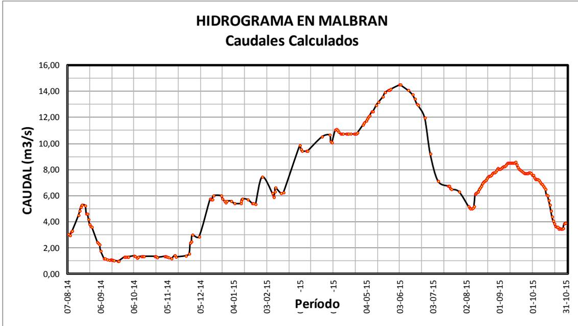
Gráfico de caudales calculados por la curva de descarga.
