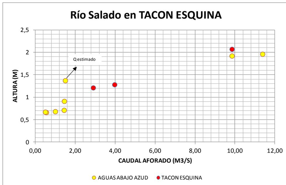
El último aforo realizado es del 17/09/2014 con  $H= 0.71\text{m}$  y  $Q= 1.44 \text{ m}^3/\text{s}$  (MASPyMA)
