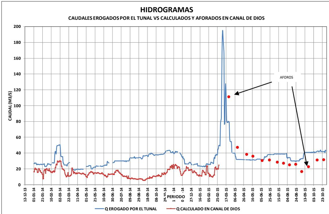
Los datos de caudales del Tunal corresponden a AES (Q Erogado) hasta el 31/10/2015. Los datos de caudales del Río Salado en C. de Dios fueron calculados por curva de descarga, no calculándose a partir de Marzo 2015 por las razones detalladas (Pto. 3.2.3.) pero se incluyen los valores aforados en esos meses.
