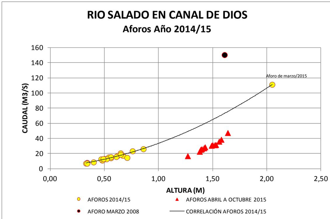
*Ploteo de Aforos del año 2014/15. Con triángulo rojo los aforos de Abril a Octubre 2015. Se presenta el aforo de Marzo 2008 como dato comparativo.*
