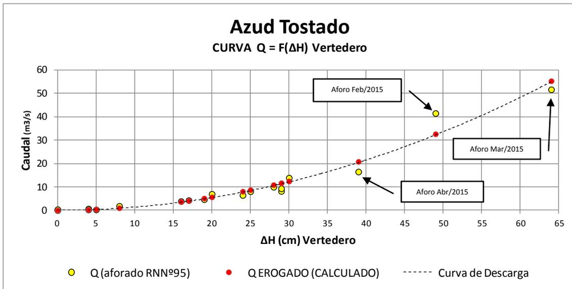
La expresión adoptada es de la forma:  $Q = 0,0132 \times (\Delta H)^2 + 0,0194 \times \Delta H$ , donde  $\Delta H$  = lámina sobre el vertedero en cm y  $Q$  = caudal erogado en m³/s
