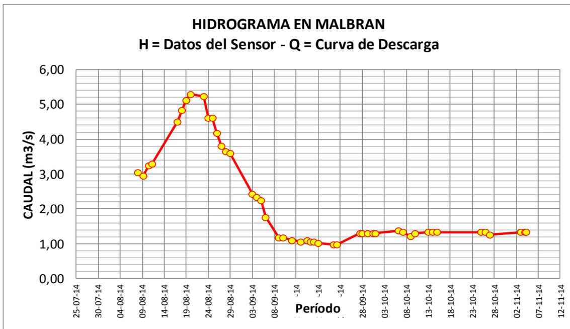
*Hidrograma calculado con alturas registradas por el sensor y caudales calculados por la curva de descarga. Período 08/08/2014 al 04/11/2014*
