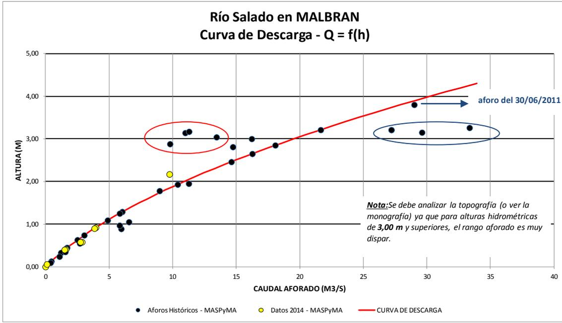
Curva de Descarga Estimada de la forma  $Q=1,06H^2+3,33H$
