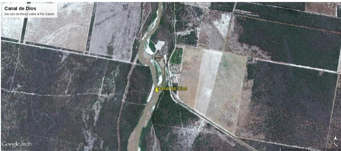
Sección de aforos sistemática del Río Salado en Canal de Dios. La posición de la flecha es estimativa.
