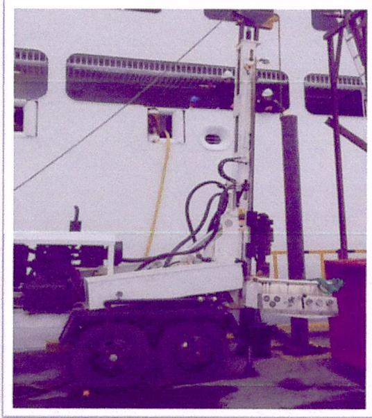
El equipo utilizado consiste en una perforadora tipo tráiler modelo YC2115 con la capacidad de perforar hasta 200 metros. La misma se trata de una unidad de perforación montada sobre una estructura móvil equipada de 4 ruedas. El equipo funciona mediante control hidráulico, dirigido a la cabeza de rotación que ejerce hasta los 40 bar a 34 revoluciones /min.
