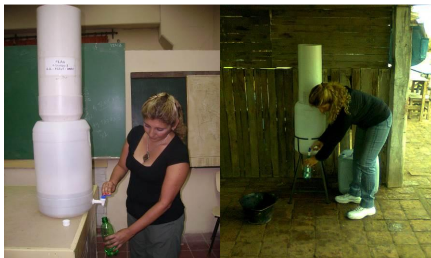
Figura 4: Ensayos de filtrado con el FLAs3 en laboratorio y la vivienda rural.
