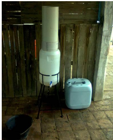
Figura 3: El FLAs3 armado y ubicado listo para el tratamiento de agua.
