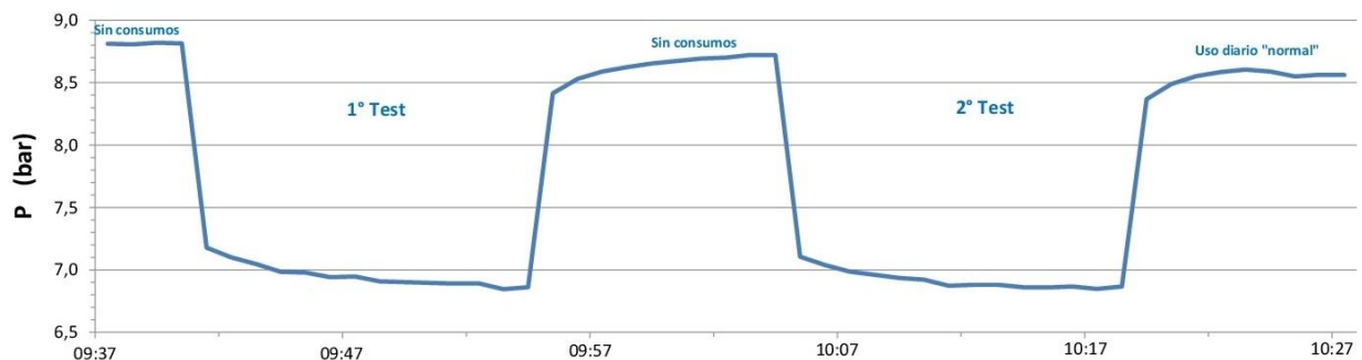
Fig. 9. Pozo S (Surgente). Tests “drawdown” a caudal constante (126 m 3 /h). Gráfico Presión–Tiempo.
