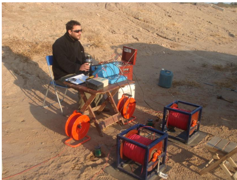
Foto 1: Dispositivo en mesa de operación – Configuración electrónica Schlumberger.
