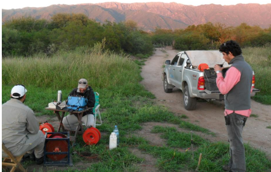
Foto: Realización del SEV 1 sobre RN N°79.
