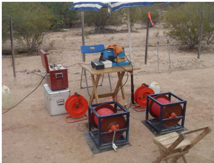
Foto 1: Dispositivo en mesa de operación – Configuración electródica Schlumberger en SEV 1.
