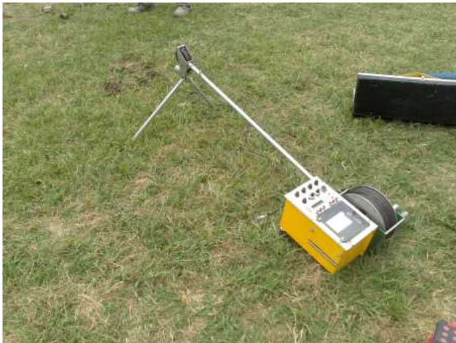
Fotografía 6. Vista equipo perfilador geofísico.
